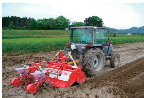
耕耘同時畝立て栽培技術 高い碎土率と湿害回避効果を有します。
