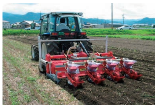
小明渠作溝同時浅耕播種技術 比較的作業速度が高く、クラスト防止効果があります。
