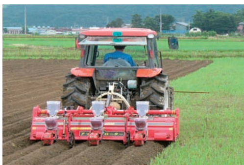
耕耘同時畝立て栽培技術 高い碎土率と湿害回避効果を有します。
