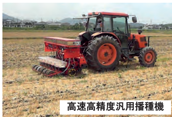
図3 不耕起播種が可能な作業機
