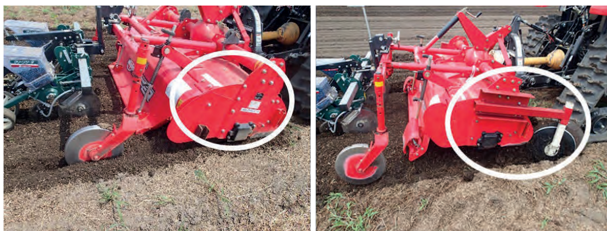
図1 改良前(左:普通耕仕様)と改良後(右:浅耕仕様)の逆転ロータリ
