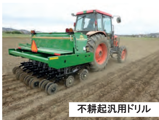
図3 不耕起播種が可能な作業機
