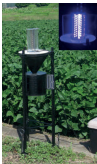
図2 開発したLEDトラップ（右上点灯時）
