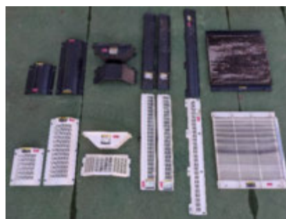
写真4 各部底板等 (上: 水稲・麦用、下: 大豆用)
