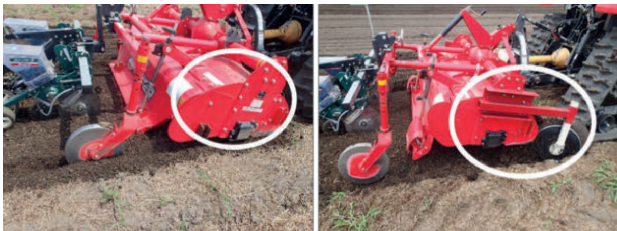
図1 改良前(左:普通耕仕様)と改良後(右:浅耕仕様)の逆転ロータリ
