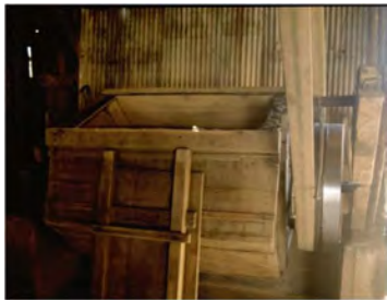
水をかけ流しながら回転箱を使って 土砂と根皮を除去し↑↑、 広げて日陰乾燥する→
