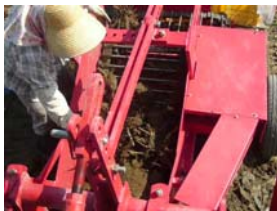
コンベア部で土が篩い落とされ、根が後方に移動する。
