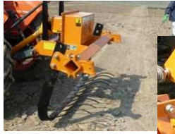
↑→振動付き デガーで苗を 掘上げる。
