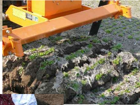
↑→振動付き デガーで苗を 掘上げる。
