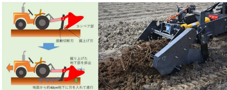
図 収穫機の動作(写真左, 村上ら 2021)および実機による収穫(写真右). ※村上ら 2021, 薬用作物栽培の手引き ~薬用作物の国内生産拡大に向けて~ カンゾウ編, 農研機構 ( https://www.naro.go.jp/publicity_report/publication/files/kanzo_warc_man2021.3.15.pdf )
