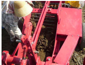
コンベア部で土が篩い落とされ、根が後方に移動する。
