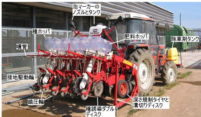
図4 汎用不耕起播種機(NSV600) 試験用に除草剤散布装置を装着している
