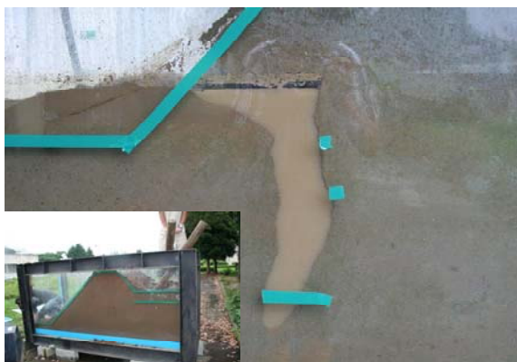
写真5 ザリガニの掘削孔 農工研における実物大試験
