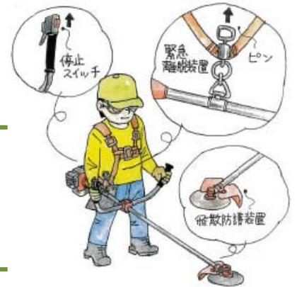
飛散物防護カバーなど、安全装置を装備する。
