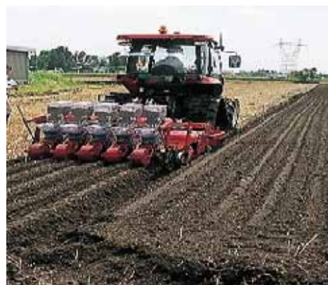
耕うん同時畝立て播種 (湿害・乾燥害防止と出芽・苗立ちの安定化)
