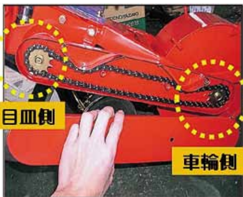
播種機の調節 (最適な株間調整や回転目皿の使用等)
