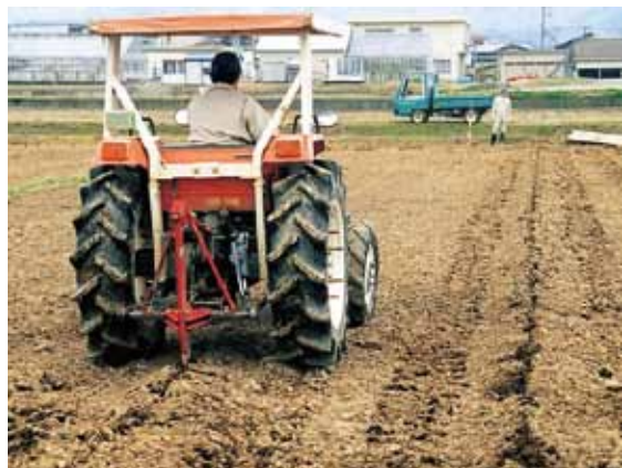
サブソイラーによる弾丸暗渠施工（左）と装着したドレーナーを明渠から貫通させ弾丸暗渠を形成（右）
