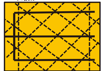
施工暗渠の模式図
