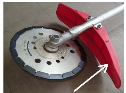
図-2 草が詰まりづらい飛散物防止カバー
