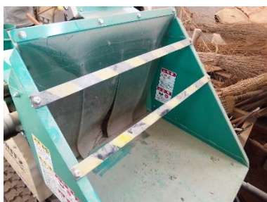
写真4 刃へ手が届かないよう、 安全ガード（トラ柄）が 設置された投入口
