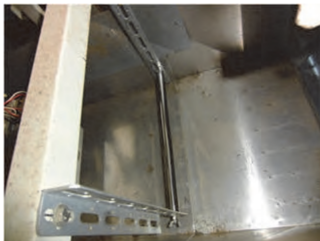
製造ライン 2ヶ所に磁石を設置
