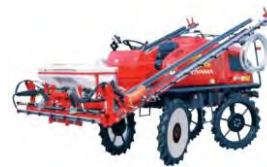
ブームスプレーヤー （農薬散布する）
