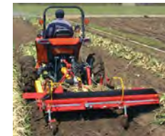
デガー （タマネギを掘り上げる）
