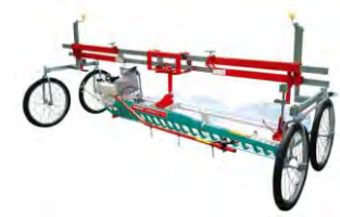
剪葉機（苗の高さを揃える）
